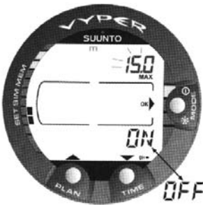
שרטוט 4.30 כיוון התראת העומק המרבי. לחץ על כפתורי הדפדוף כדי להפעיל / להפסיק וכדי לשנות את ערך העומק
