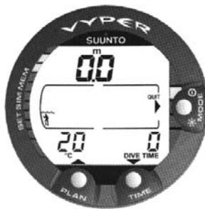
שרטוט 4.18 בחירת מצב סימולטור צלילה. ירידה ע"י לחיצה על החץ למטה (TIME). עליה ע"י לחיצה על החץ למעלה (PLAN)
