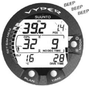
שרטוט 3.23 מסכי הלחץ החלקי של החמצן וה- OLF. צפצוף ישמע כאשר הלחץ החלקי של החמצן השיג 80% מ- OLF ב- 1.4 באר או ערך אחר שהוכנס.
