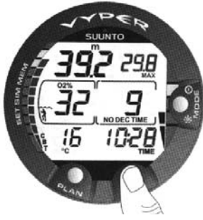
שרטוט 3.24 מסך אלטרנטיבי לחיצה על כפתור TIME מציגה את השעה, עומק מרבי ו-CBT
