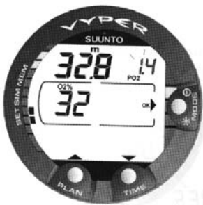
שרטוט 4.32 כיוון אחוזי חמצן ולחץ חלקי של חמצן. העומק המקסימאלי המתאים לנתונים הוא 32.8 מטר [107 רגל]. לחץ על כפתורי הדפדוף כדי לכוון את אחוזי החמצן
