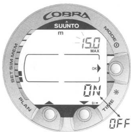
שרטוט 4.26 כיוון התראת העומק המרבי. לחץ על כפתורי הדפדוף כדי להפעיל / להפסיק וכדי לשנות את העומק הרצוי.
