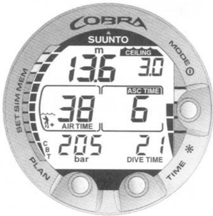
איור 3.16 צלילת דקומפרסיה מתחת לעומק הרצפה. החץ המורה מעלה והכתובת ASC TIME המהבהבת לעלות. הזמן המינימאלי לעלייה כולל חניית בטיחות הוא 7 דקות. עומק התקרה הוא 3 מטר [10 רגל].
