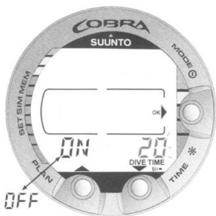
שרטוט 4.25 כיוון התראת זמן הצלילה. לחץ על כפתורי הדפדוף כדי להפעיל / להפסיק את ההתראה וכדי להכניס את הזמן הרצוי
