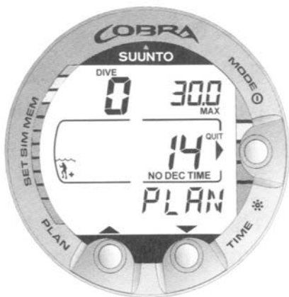
איור 3.6 תכנון צלילה. מצב תכנון מסומן ע"י הכיתוב PLAN. הזמן ללא דקומפרסיה בעומק 30 מטרים הינו 14 דקות במצב A0/P1
