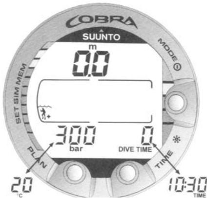
איור 3.3 הפעלה III. מצב מעל פני המים: עומק זמן צלילה מאופסים ולחץ המיכל הוא 300 אטמ'. לחיצה על כפתור הזמן מפעילה את תצוגת הזמן והטמפרטורה
