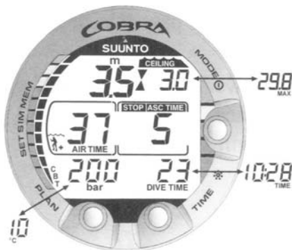
איור 3.17 צלילה דקומפרסיה מעל עומק רצפה. החץ המורה מעלה נעלם והכתובת ASC TIME אינה מהבהבת, כלומר היד נמצא בתחום
