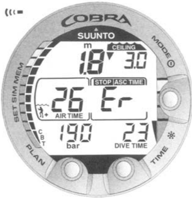
איור 3.19 צליקת דקומפרסיה מעל עומק התקרה. שים לב לחץ המורה מטה ולאזהרת השגיאה Er. כמו כן ישמע צפצוף. עליך לרדת מיד (בתוך 3 דקות) אל או מתחת לעומק התקרה
