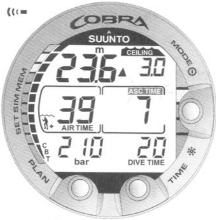
איור 3.16 צלילת דקומפרסיה מתחת לעומק הרצפה. החץ המורה מעלה והכתובת ASC TIME המהבהבת לעלות. הזמן המינימאלי לעלייה כולל חניית בטיחות הוא 7 דקות. עומק התקרה הוא 3 מטר [10 רגל].
