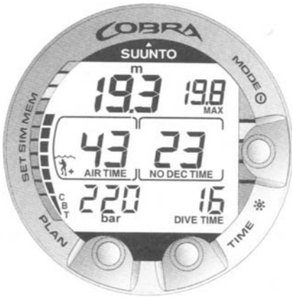
איור 3.8: תצוגת צלילה. העומק הנוכחי 19.3 מטרים וזמן הצלילה ללא דקומפרסיה הוא 23 דקות במצב A0/P1. העומק המרבי 19.8 מטרים, וזמן הצלילה שעבר הנו 16 דקות.
