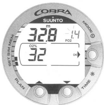
שרטוט 4.26 כיוון התראת העומק המרבי. לחץ על כפתורי הדפדוף כדי להפעיל / להפסיק וכדי לשנות את העומק הרצוי.
