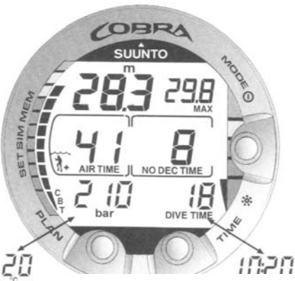
איור 3.9: תצוגת צלילה. לחץ המיכל 210 אטמוספרות, וזמן האוויר שנותר הוא 41 דקות. תצוגה חליפית של טמפרטורה ושעה מוצגת למשך 5 שניות לאחר לחיצה על כפתור הזמן.
